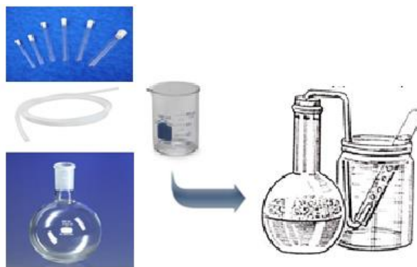
ნახ. 5.1. სპირტული დუღილისათვის განკუთვნილი, მეისელის ჩამკეტიანი გადამყვანით აღჭურვილი ხელსაწყო
